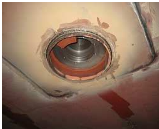
De bus waarin binnenkort de 'thruster' wordt gemonteerd
