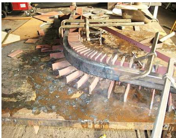
Stuk voor stuk worden de spanten op maat gebogen
